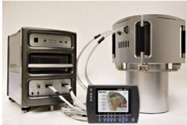
Bild 1: Das UltraCam-X System, Vexcel Imaging GmbH, Graz. Bildgröße 14430 x 9620 Pixel. Panchromatisch-Rot-Grün-Blau-Infrarot in jedem Bild. Die Sensoreinheit (rechts) mit Daten- und Rechereinheit (links) und Nutzerdisplay mit Echtzeitwiedergabe (Vordergrund)
