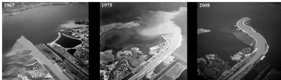
Abb. 1: Verlandungsprozess und Mündungsbauwerke der Rheinvorstreckung (IRR,1990)
