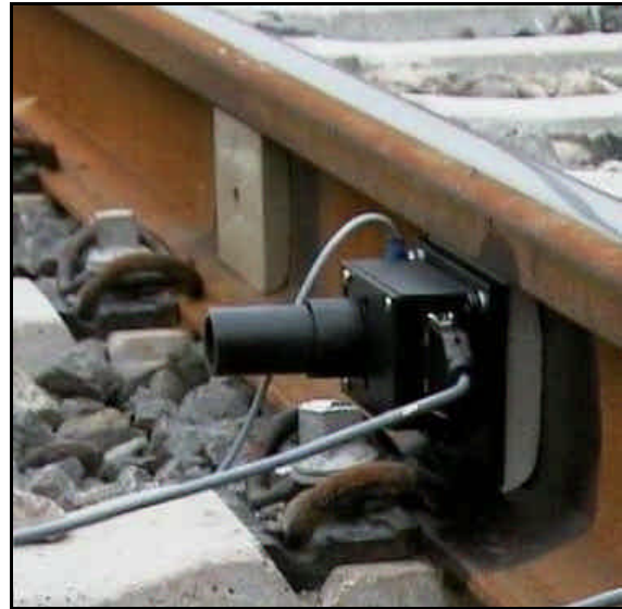
Abbildung 3: Am Schienensteg befestigte Detektoreinheit.
