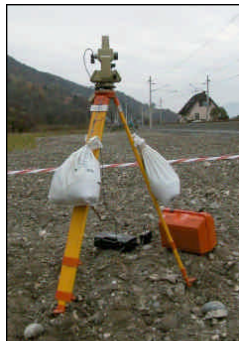
Abbildung 2: Theodolit mit aufgesetztem Diodenlaser im Einsatz.
