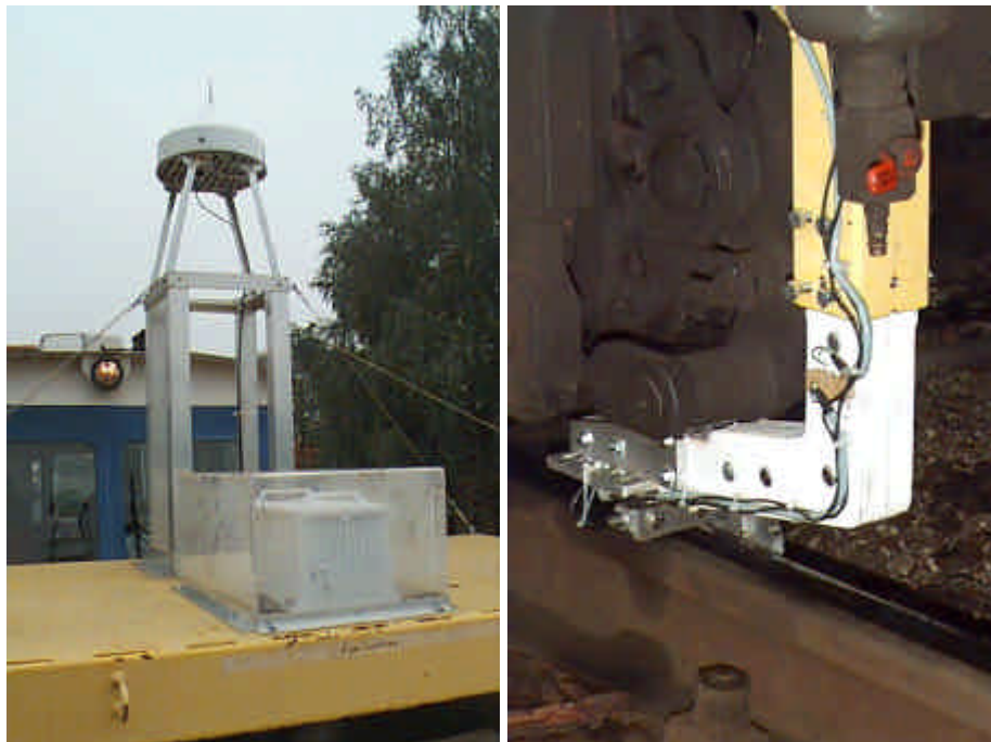
Abbildung 6: Strapdown INS Sigma30 mit GPS Chokering Antenne (links). Die rechte Abbildung zeigt den linken Messarm der Plattform, der am unteren Ende die beiden Ultraschall-Sensoren zur Messung der vertikalen und horizontalen Entfernung zum Gleiskopf aufnimmt
