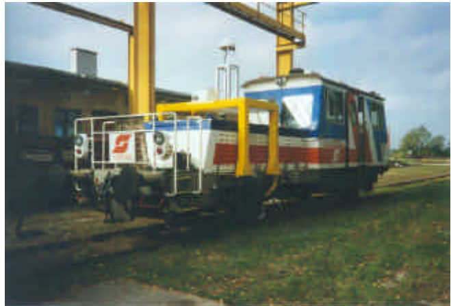
Abbildung 2: Messfahrzeug der Österreichischen Bundesbahn (ÖBB) mit aufgesetzter Messplattform
