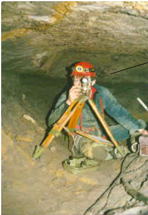
Abb. 5 Nivellement im Bereich Pätz 5
